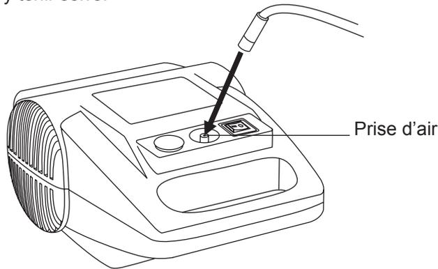
10. Insérez fermement le tube situé sous le réceptacle du nébuliseur dans l'autre embout du tube à air, tel qu'illustré.
