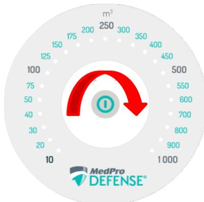
Sélectionner le volume à traiter en faisant glisser le doigt sur la partie claire du clavier.
