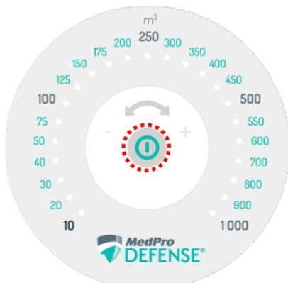
Après avoir sélectionné le volume, appuyer sur le bouton au centre du clavier pour démarrer (un appui long est nécessaire) Vous entendrez un bip.
