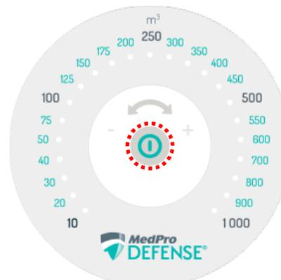
L'appareil peut être arrêté en ré-appuyant au centre du clavier. **(vous entendrez un bip lorsque le traitement est arrêté manuellement)**
