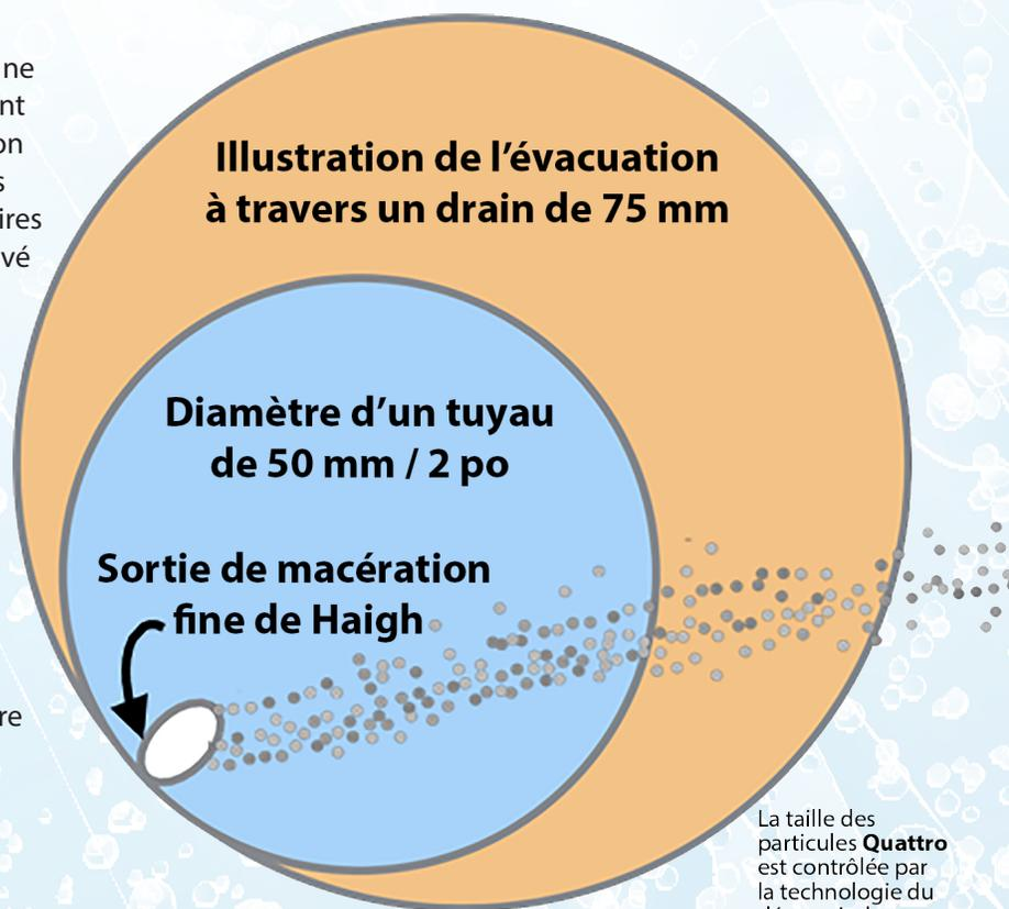
La taille des particules **Quattro** est contrôlée par la technologie du déversoir de mesure
